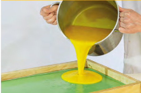
1 Flüssige Seifenmasse wird in Holzboxen 24 Stunden gelagert: der Seifenleim härtet
